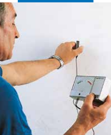
Vérification de l'humidité du plâtre
